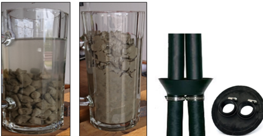
Figur 9. Bentonitpellets (Dantonit) i vattenfyllt glas, efter 10 min. respektive 12 tim (foto, Olof Andersson). Till höger exempel på stöd för pelletstätning (Med tillstånd från DeBe Flow Group och Muovitech AB)
