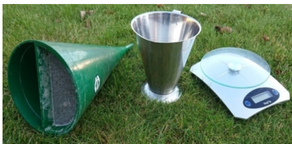
Figur 3. Enkel utrustning för mätning av blandningens viskositet och densitet, en viskositets-tratt, ett enliterskärl och en hushållsvåg. Foto: O Andersson
