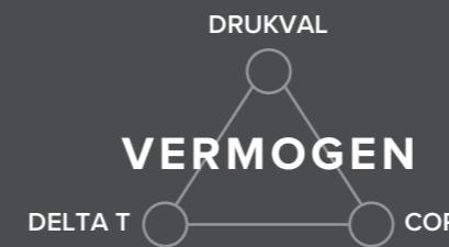
**LAGE DRUKVAL IS VAN AFDOENDE BETEKENIS VOOR EEN EFFECTIEVE WERKING VAN EEN GEOTHERMISCHE ENERGIESYSTEEM. EEN TE HOGE DRUKVAL LEIDT TOT EEN SLECHTERE DELTA T, COP EN VERMOGEN VAN DE WARMTEPOMP.**
